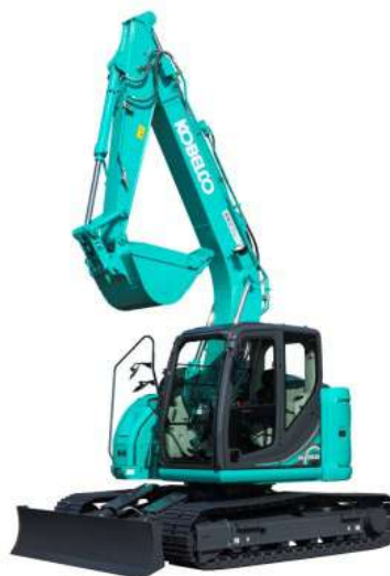
写真-1 自動運転に使用した油圧ショベル
