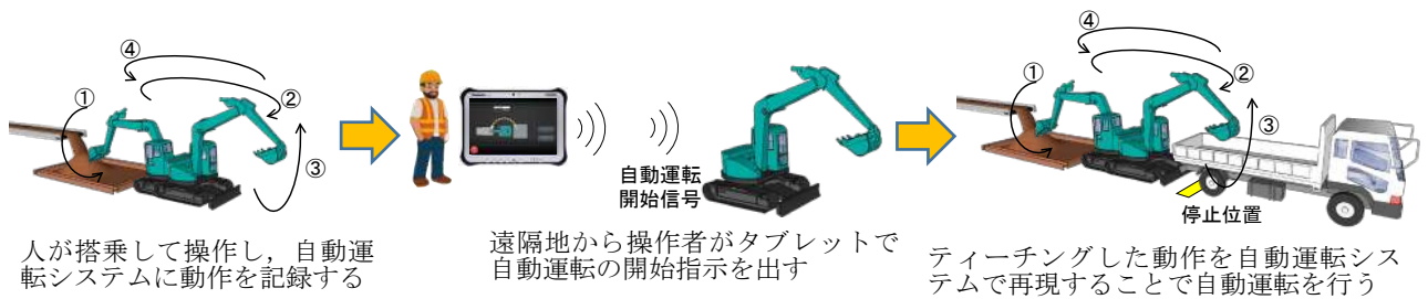
図-2 自動運転の作業手順
