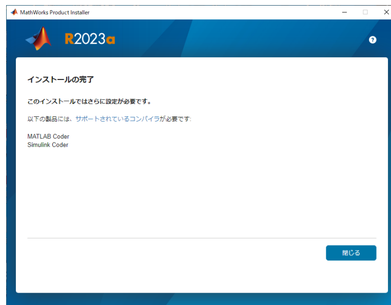
図 1-16 コンパイラ警告
