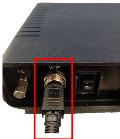
図 3-1 電源ケーブルの接続
